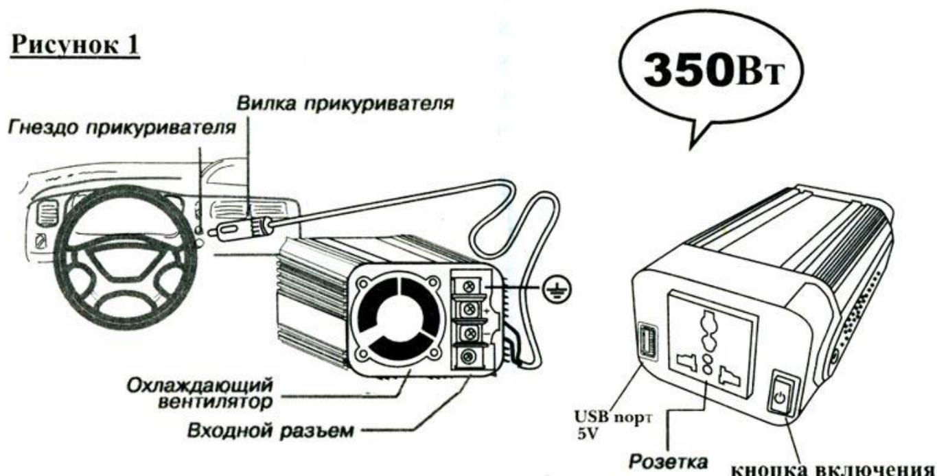
Схема инвертора содержит элементы температурной защиты, защиты от перегрузки, неправильной полярности, низкого и высокого входного напряжения и от короткого замыкания (зависит от модели).
